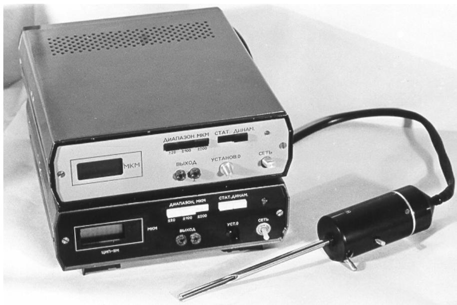
Рис. 1. Общий вид устройства для внутриволостного измерения механического импеданса биологической ткани
