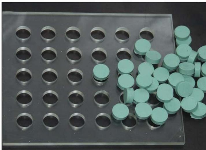
Рис. 5. Шаблон из плексигласа и изготовленные таблетки силиконового материала
