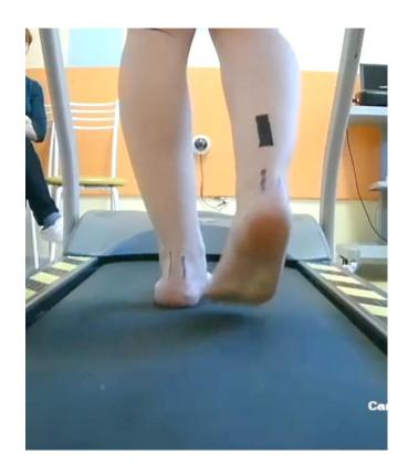
Рисунок 3. — Фронтальная плоскость (вид сзади) для оценки опоры стопы и угла перемещения
